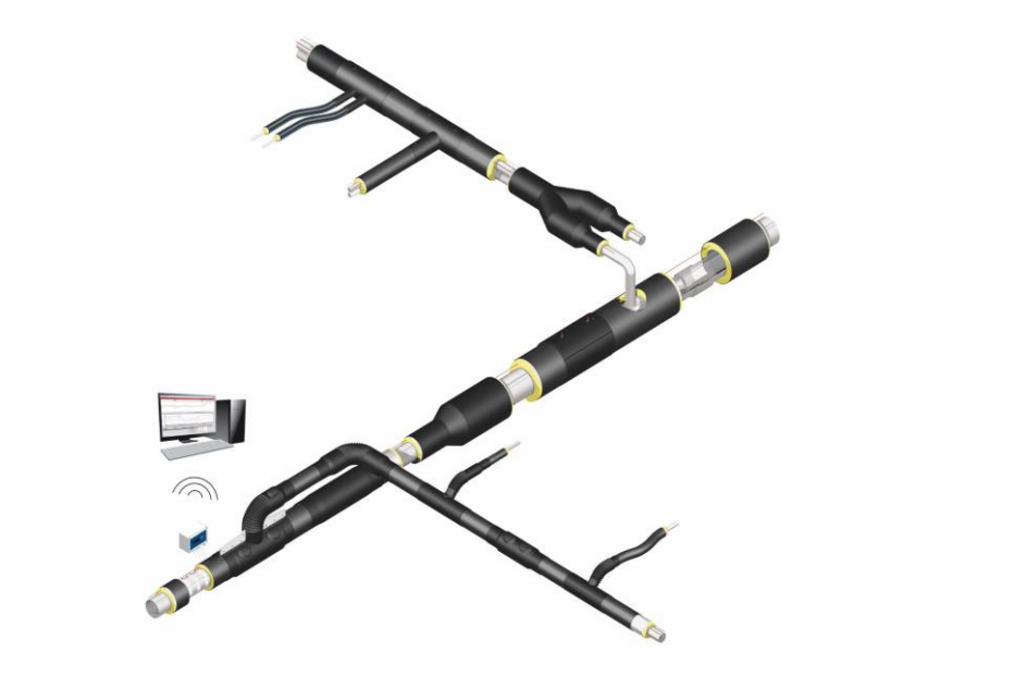
Şekil 34 Ön izolasyonlu Borularla Kaçak İzleme
